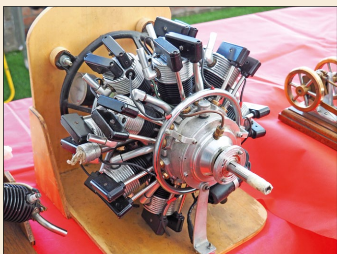
Dvojhvězdicový čtyřdobý benzinový modelářský motor
