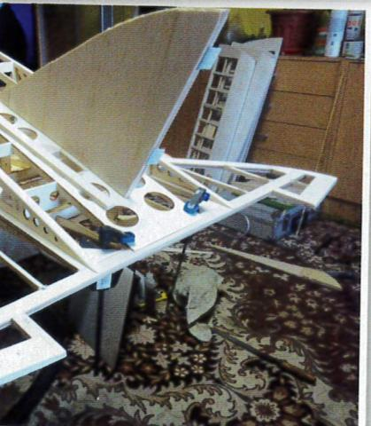
Olda zhotvil překližkové kopyto překryté hliníkovou folií a pomocí horkovzdušné pistole zhotobil z durofolu zasklení. Kabina má funkční otevírací dveře, opatřené panty jako mělo skutečné éro. Podvozek je zhotoven z duralového plechu tl. 4 mm. Je oboustranně polepen balzou 4 mm,
