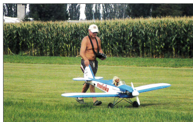
FLY - BABY Roberta Gogola ze SLML, novinka létá již 14 let, motor z křovinořezu o objemu 31,5 ccm
