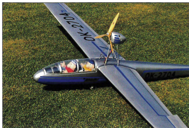
Blaník L-13 s pomocným elektromotorem Ing. Hýbla
