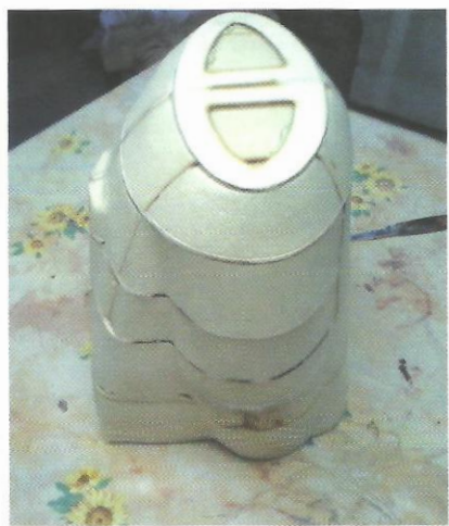
Asi nejdůležitější konstrukční část – centroplán s lomenými žebry se spojovací trubicou a střední částí trupu
