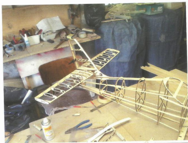
Asi nejdůležitější konstrukční část – centroplán s lomenými žebry se spojovací trubicou a střední částí trupu
