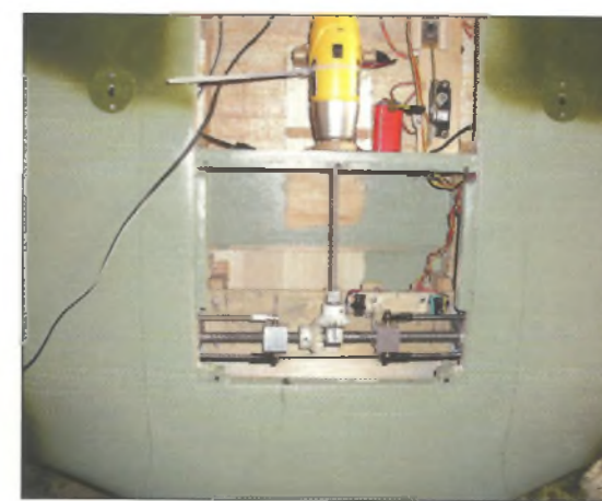
Pohon náhonu otevírání podvozku akušroubovákem
