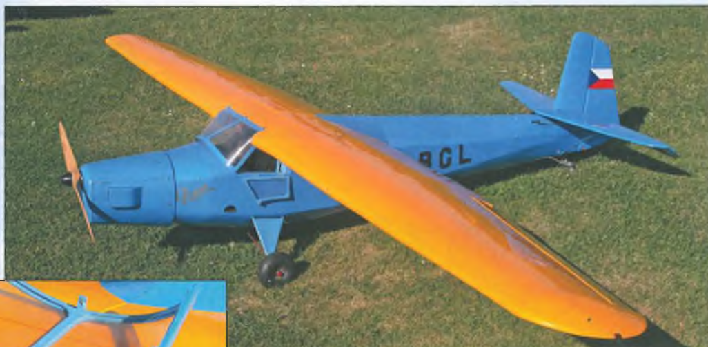
Jak-3 Jiřího Petra o rozpětí 2,3 m pohání motor MVVS 45 cm 3
