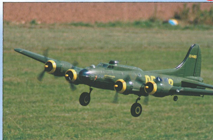
Bombardér B-17 Alice Svobodové z SLML Litomyšl, jediné ženské účastnice. Model o rozpětí 1,8 m pohání čtyři elektromotory.
