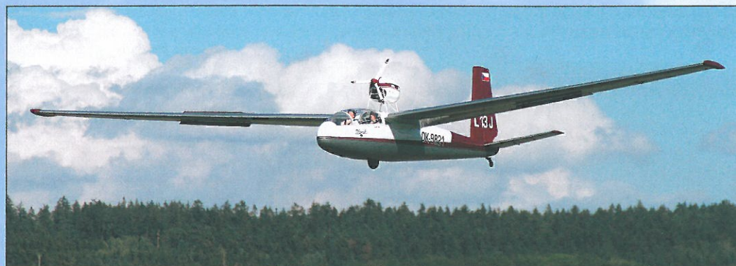
Maketa motorizovaného větroně L-13J Blaník Antonína Dodka má rozpětí 6,5 m a pohání ji benzinový motor ZDZ 50 NG
