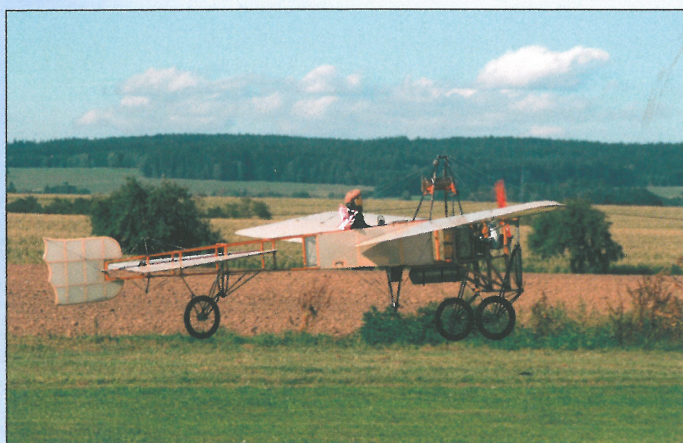
Blériot Jiřího Fikejze z Letky Jehnědů má rozpětí 3,1 m, motor MVVS 80 a hmotnost 17,5 kg
