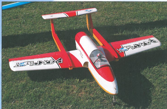
Bumerang Nano Jiřího Nedvěda má rozpětí 1,7 m, hmotnost 7,5 kg a pohání jej proudový motor Wren 80
