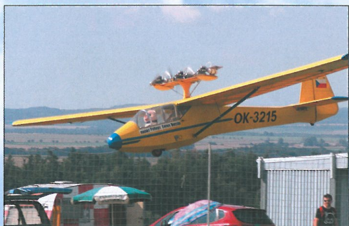
Pionýr Roberta Gogola se třemi pomocnými motory MVVS 6,5 cm 3 ; model má rozpětí 4,2 m a hmotnost 11,5 kg.
